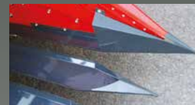
Делители закрытой конструкции из износостойкой стали.
