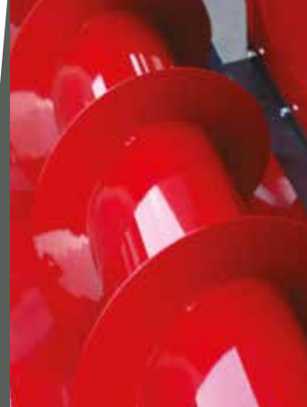
Шнек цельной конструкции обеспечивает непрерывный поток массы в комбайн.
